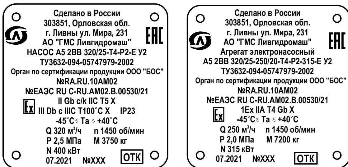
Рисунок 3 – Фирменная табличка (пример оформления)
